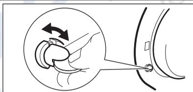
Если данное устройство включено, то закрыть дверцу невозможно. Это позволяет избежать опасности заперения дверцы в случае попадания в барабан детей или домашних животных. Чтобы включить данное устройство, поверните переключатель по часовой стрелке так, чтобы канавка оказалась в горизонтальном положении. Чтобы выключить данное устройство, поверните переключатель против часовой стрелки так, чтобы канавка оказалась в вертикальном положении.
