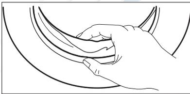
Регулярно проверяйте состояние барабана, во избежание образования накипи и частичек ржавчины.
